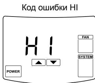
Текущая температура в помещении выше плюс 40°С
